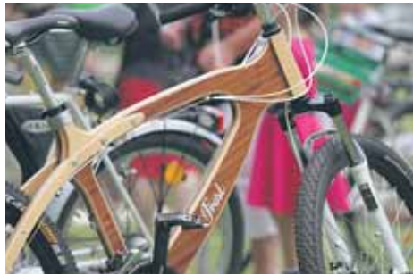
Wyjątkowy eko rower. Rama wykonana całkowicie ze sklejki drewnianej
